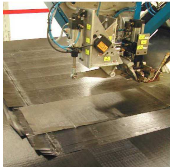
Obrázek 2. Pokládka vrstev strojem*
