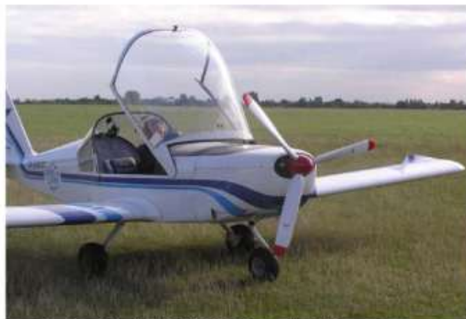
Obr. 12 – Vrtule VZLU V331-3C s listy V36o při přípravě pozemních a letových zkoušek
