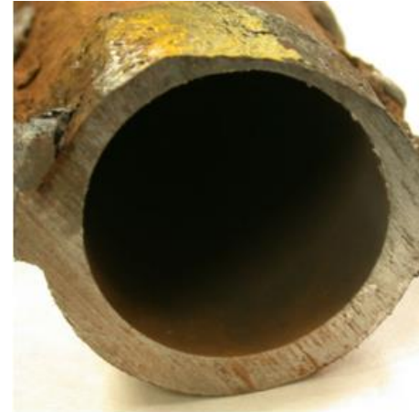
Obr. Teplosměnná trubka (vlevo) a membránová stěna (vpravo) po těžkém napadení hot corrosion ;
