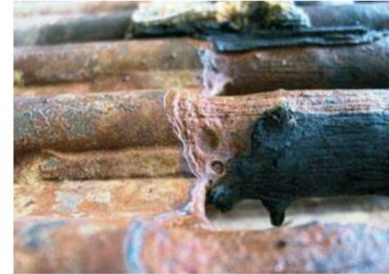
Obr. Teplosměnná trubka (vlevo) a membránová stěna (vpravo) po těžkém napadení hot corrosion ;
