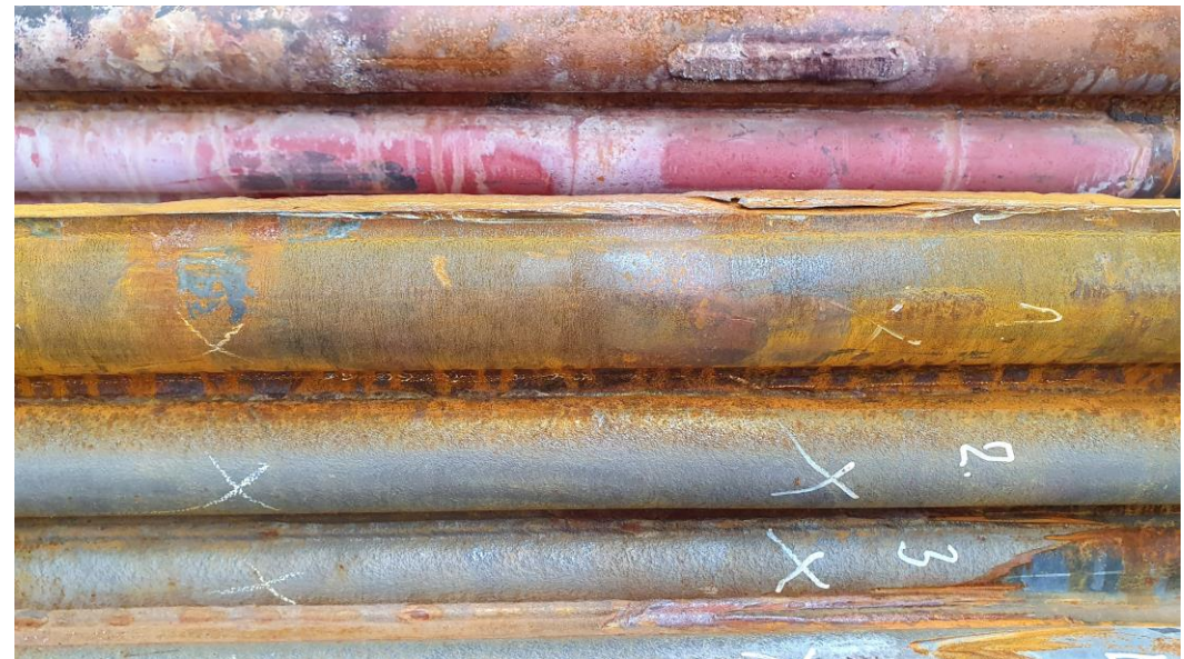
Obr. Teplosměnná trubka (vlevo) a membránová stěna (vpravo) po těžkém napadení hot corrosion ;
